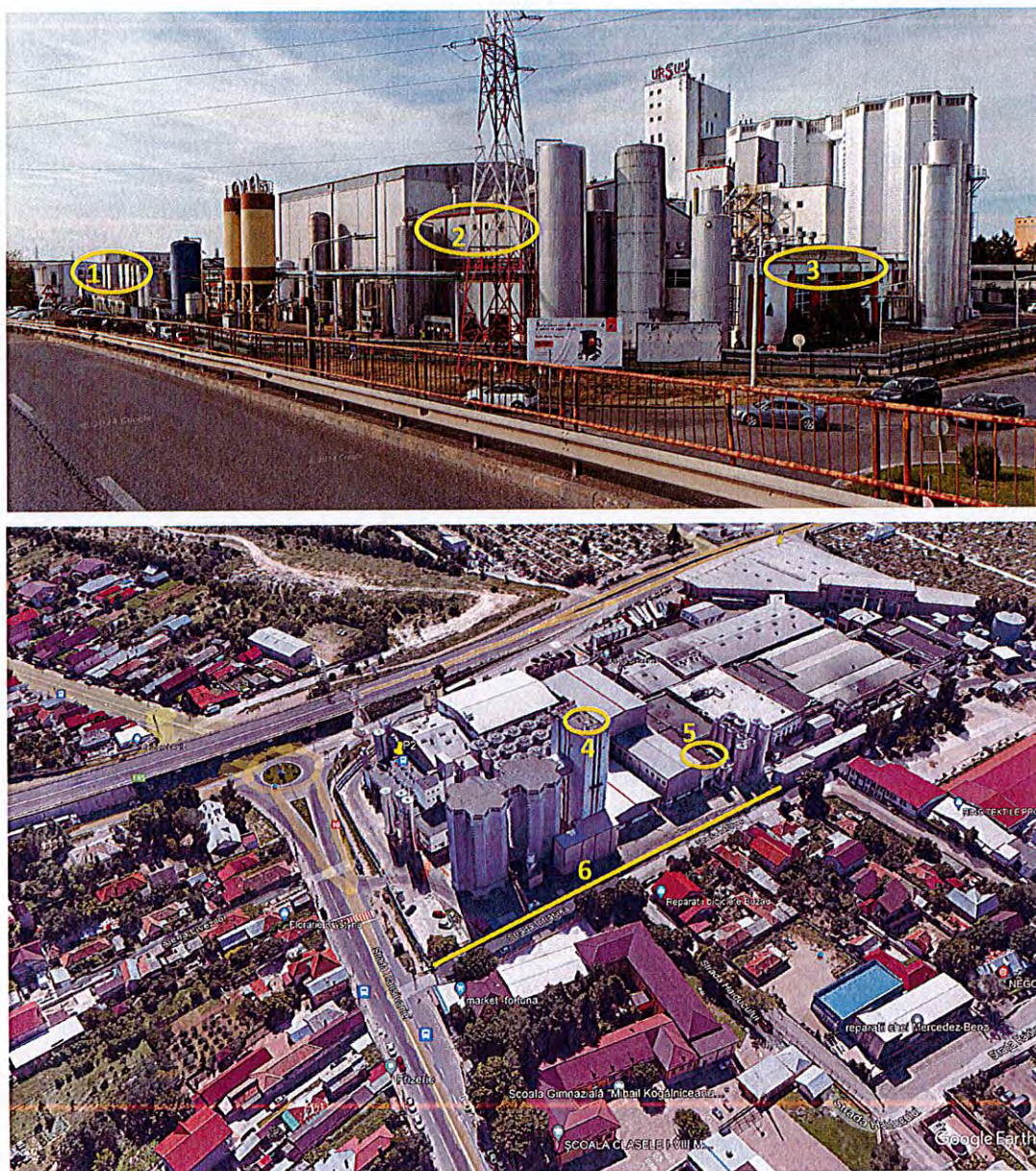
Fig. 29: Imagini URSUS BREWERIES (Google Earth), cu marcarea surselor de zgomot necesar a fi tratate antizgomot și a ecranului propus (6)
