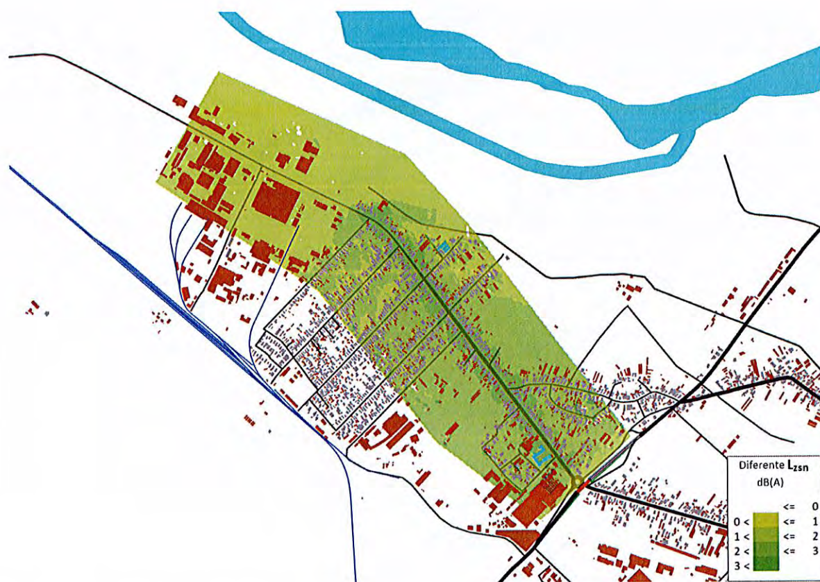
Fig. 16: DN10 – Harta de diferențe dintre nivelurile de zgomot corespunzătoare situației existente și cele corespunzătoare situației de după introducerea limitării de viteză
